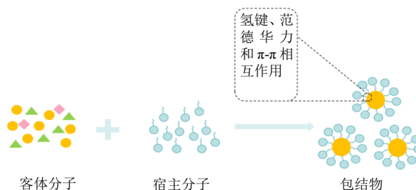
图 5 包结物结晶技术分离原理
