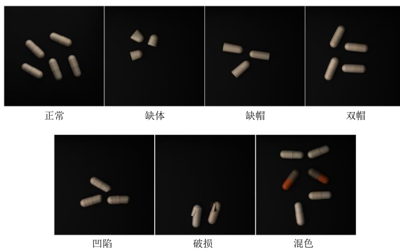
图 2 不同状态的胶囊样例
