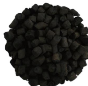
图 1 马弗炉烧制后的牛膝炭外观图
