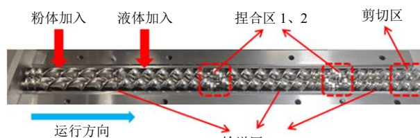
图 1 双螺杆结构及功能分区
