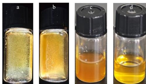
图4 以甲醇 (a)、乙醇 (b)、水 (c) 和 75%乙醇 (d) 为提取溶剂所得组装体的光学图
