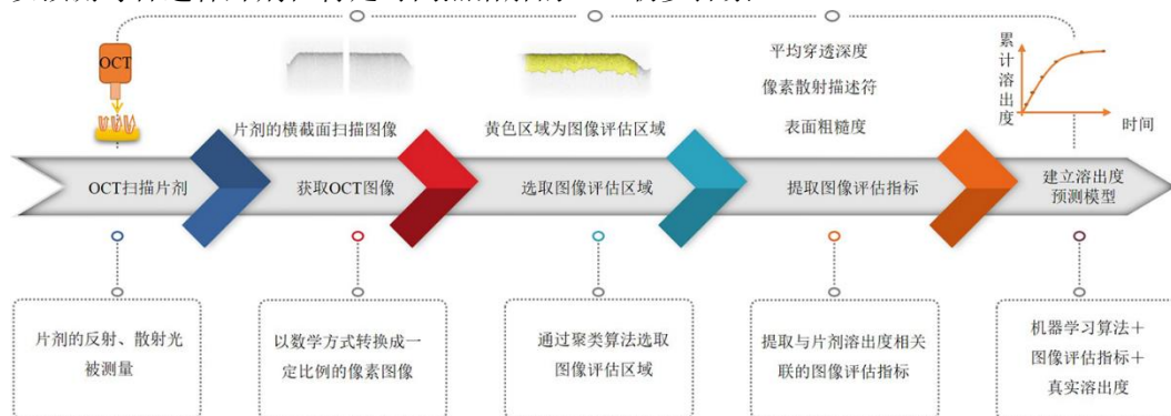
图 4 OCT 预测片剂溶出原理图
