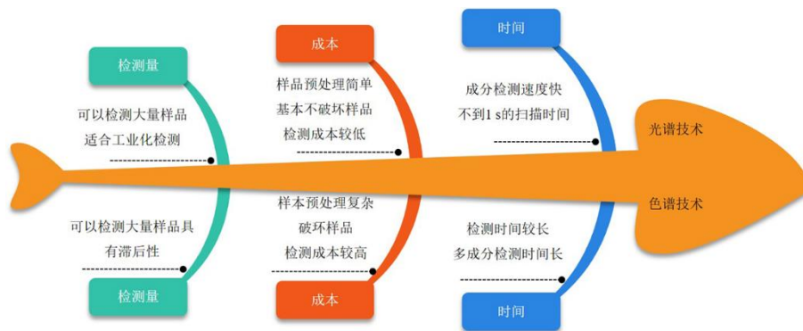
图 2 光谱技术与色谱技术在成分检测方面的比较
