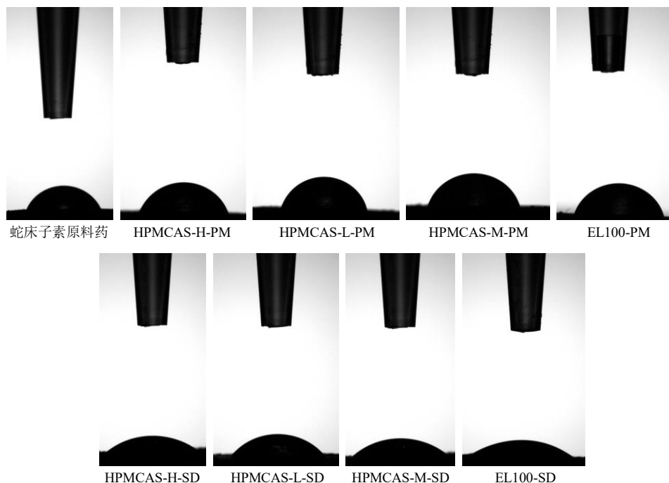
图 9 蛇床子素原料药、Ost-PMs 和 Ost-SDs 的水接触角照片
