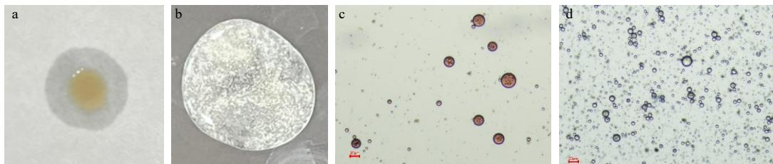
图 7 Pickering 乳稀释后外观 (滤纸法, a; 稀释法, b) 和显微镜观察结果 (苏丹 III 染色, c; 亚甲基蓝染色, d)
