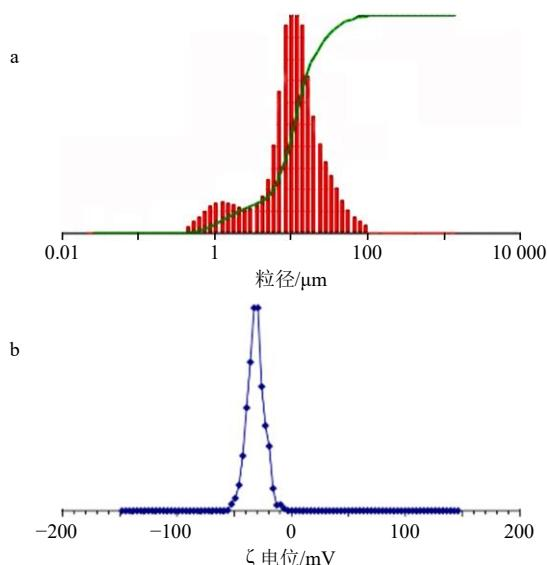
图 8 Pickering 乳的粒径分布 (a) 和  $\zeta$  电位 (b)
