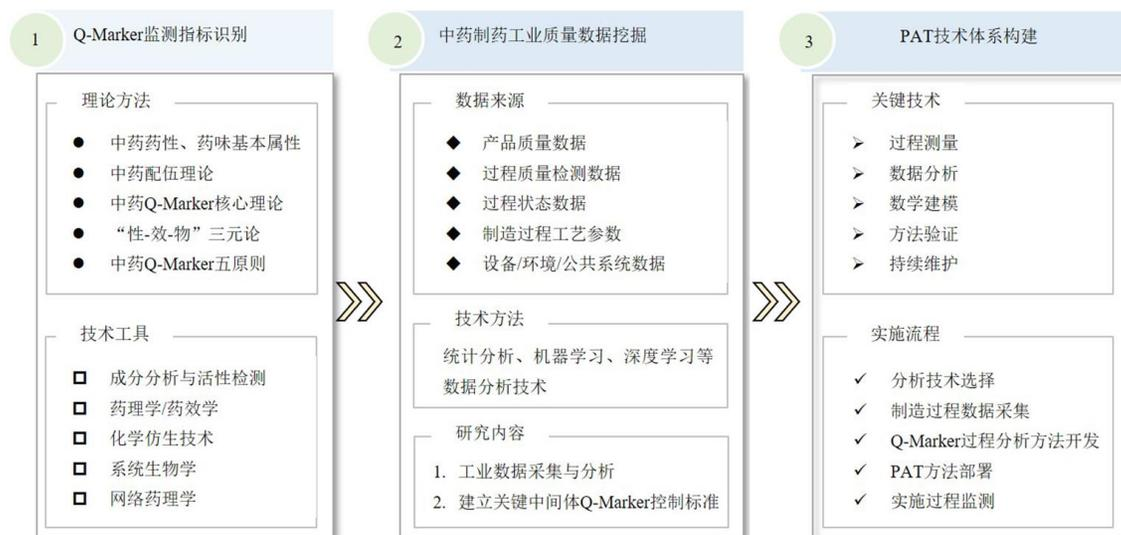
图 1 基于数据驱动的中药 Q-Marker 过程监测方法技术路线
