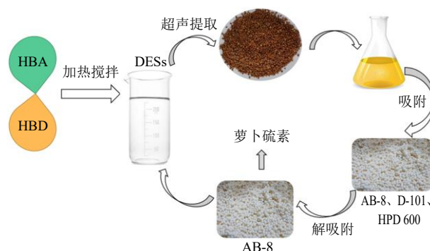
图 1 DESs 提取莱菔子中萝卜硫素的流程
