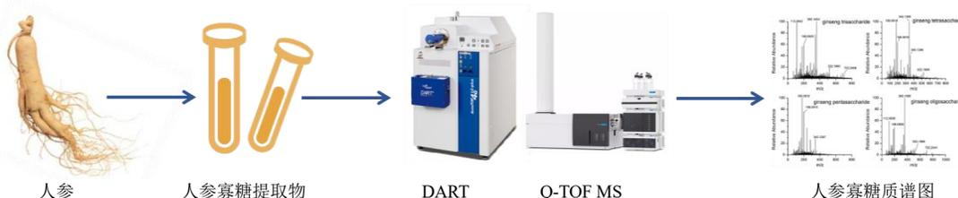
图5 新型敞开式质谱-实时直接分析样品示意图
