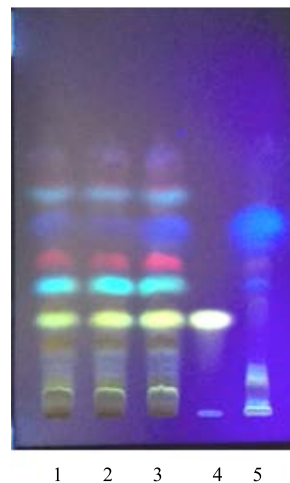
1~3-SDP 供试品(批号 140917、140730、140705) 4-补骨脂素对照品 5-缺北沙参阴性对照溶液 1—3-SDP (Lot 140917, 140730, 140705) 4-psoralen reference substance 5-negative sample without Glehniae Radix
