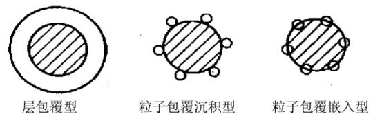
图 1 包覆式复合粒子形态
