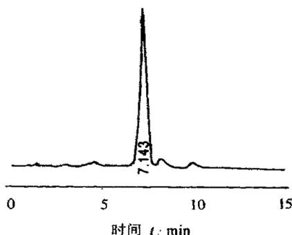
图 1 绿原酸 HPLC 色谱图
