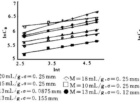
图 2 不同粒度  $\sigma$  和溶剂倍量  $M$  下的浸提时间与丹参酮浓度的关系
