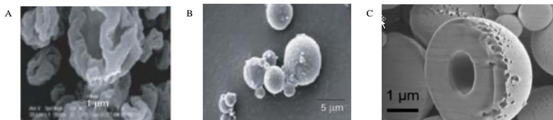
图3 喷雾干燥得到的色甘酸钠(A)、布地奈德(B)和空心牛血清蛋白(C)颗粒SEM图
