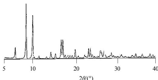
图 4 盐酸莫西沙星的 PXRD 图
