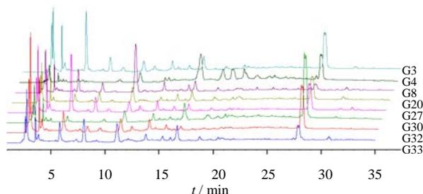
图 3 大叶骨碎补药材(共 8 批)的 HPLC 指纹图谱
